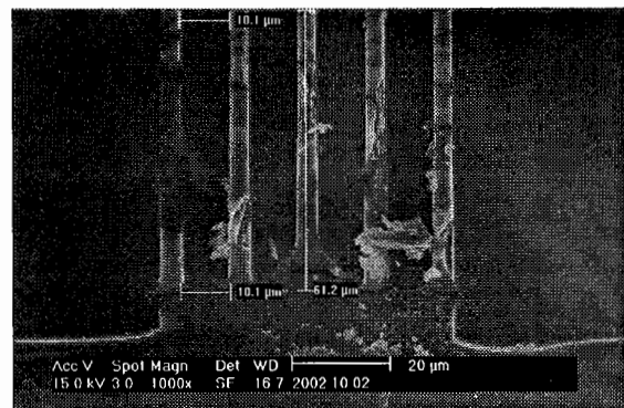
b) 식각속도 : 1.22µm/min, Profile : 90°
